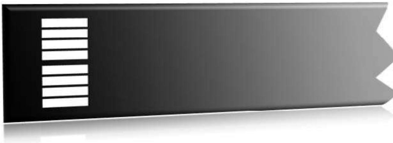
È l'inizio della pista utile per l'atterraggio. I markings di soglia pista (THR - Threshold) devono essere previsti su tutte le piste pavimentate destinate al trasporto aereo commerciale. Essi sono costituiti da una serie di strisce parallele (usualmente denominate "pettine"), lunghe almeno 30 m, disposte simmetricamente rispetto all'asse pista e con origine a 6 m dall'inizio della pista utile per l'atterraggio.
