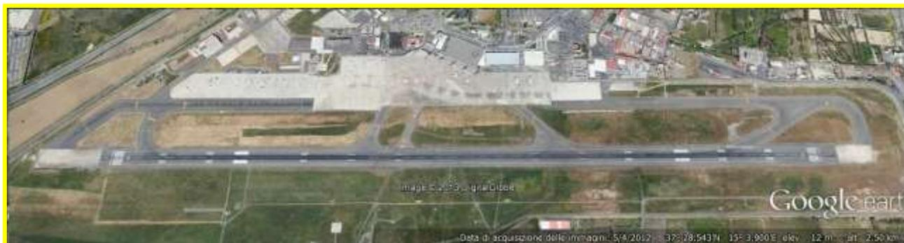
Tale configurazione con 3 raccordi centrali, 2 in testata 08 e 2 in testata 26, ha permesso di ridurre i tempi di occupazione della RWY ed aumentare la Capacità (numero di movimenti nell'unità di tempo) dell'Aeroporto.
